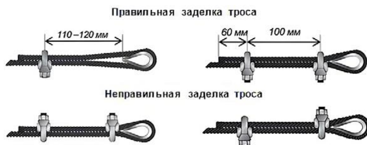
Рисунок 6 – Заделка троса
